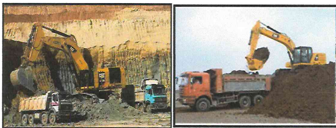
Figura 4: A) Arranque y carga directa, B) Carga desde acopios temporales ( 150m^3 ), C) Arranque de material mediante utilización de retroexcavadora de banda.
